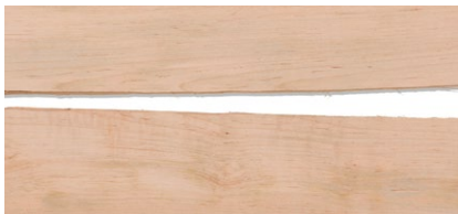
TROCKNUNGSRISS Trennung der Holzzellen längs zur Faser, die bei der Trocknung entsteht.
